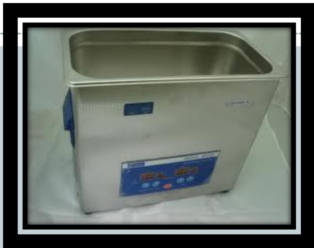
เครื่องล้างอุปกรณ์ (Ultrasonic cleaner) โดยให้น้ำสั่นที่มีความถี่สูง
